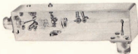
Fig. 11 b - Il duplicatore di fig. 10 visto dalla parte del cablaggio.
